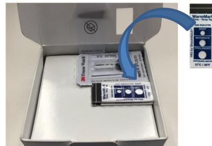
高温度インジケータの裏の貼付用のシールをはがし、元の高温度インジケータ上に重ね貼りする（外窓から見える状態）
