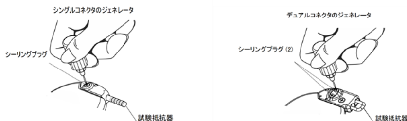
図 42. シングルまたはデュアルピンコネクタへの試験抵抗器の接続
