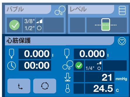
心筋保護センサーモジュールは、ローラーポンプ150もしくはダブルヘッドポンプ85を使用して、手術中に心筋保護液、もしくは血液心筋保護液を供給することができます。ディスプレイモジュールのメニューにて、2種類の操作モードを選択することができます。
