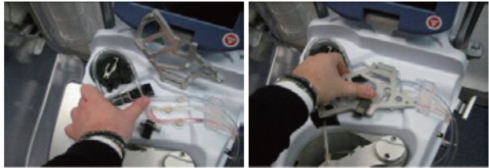
図 4-8 ポンプチューブカートリッジの装着（左）、クランプカバーを閉じる（右）
