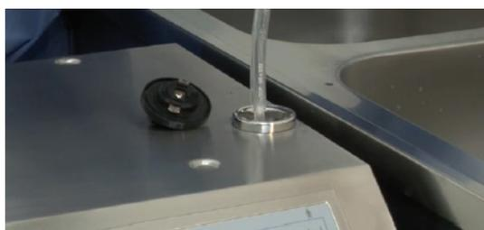
2.2 150mlの過酸化水素水 (H<sub>2</sub>O<sub>2</sub>) を注入する。
