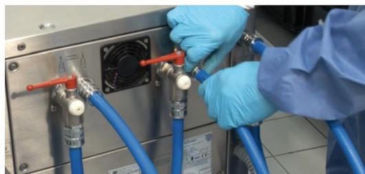
2.5 ホース類や機器へのコネクタを消毒中は、心筋保護回路の注入口と患者回路1への注水口の間を短絡回路で接続する。
