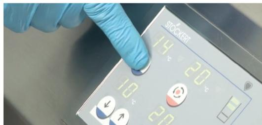
2.7 心筋保護回路の冷水槽を停止する。
