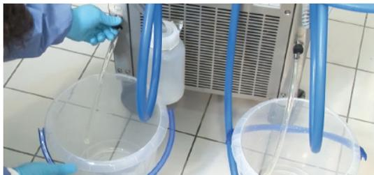
1.2 タンク内を空にした後、排水管のバルブを閉じたことを確認する。
