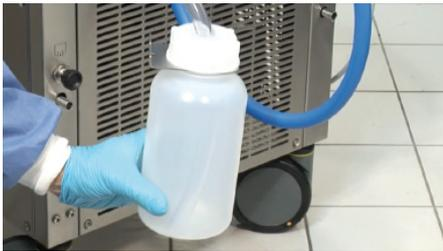
3.2 オーバーフローボトルを、洗浄消毒器の自動消毒により化学的・熱的に消毒する。
